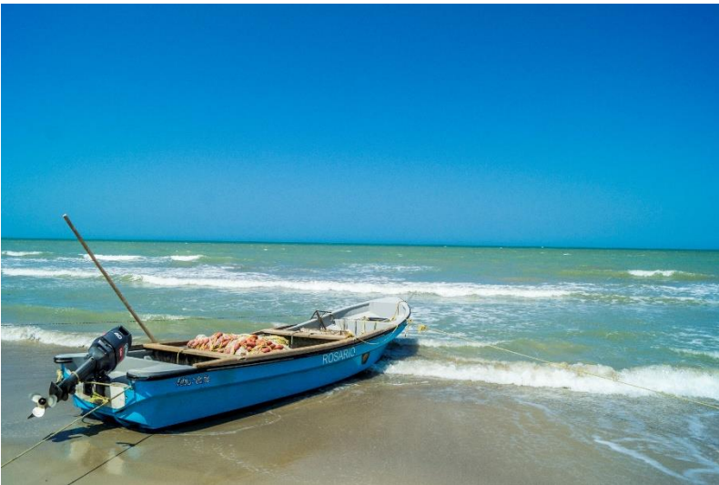
Embarcación pesquera artesanal tipo lancha con casco en fibra de vidrio y motor fuera de borda de 40 HP
