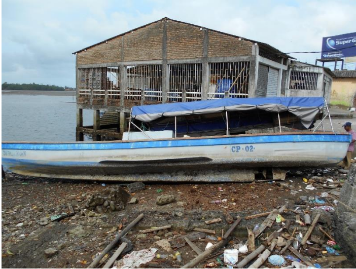
Embarcación artesanal para la pesca de espinel, casco construido en fibra de vidrio y motor interno
